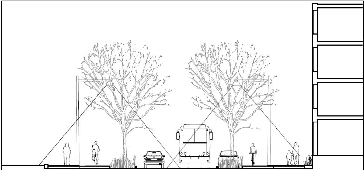
Figur 3-2. Eksempel på fordelingsvej. Dette er et snit fra den vestlige del af Blekinge Boulevard.
